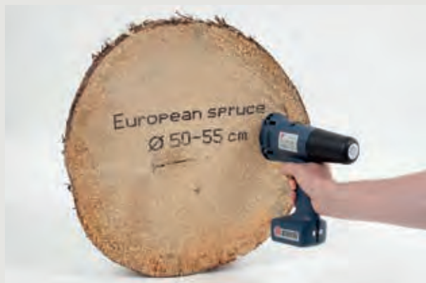
→ Madeira em corte impressa com tinta preta universal (etanol); grandes espaçadores.
