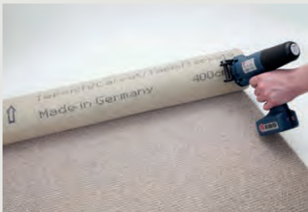
→ Carpete impresso com tinta preta universal (etanol); Estabilizador de 4 rodas
