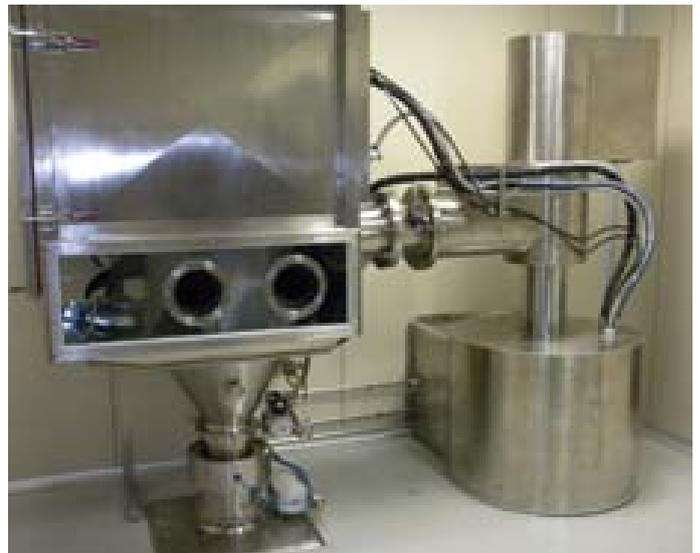
Scarico fusto da glove box con STERI LIFT
