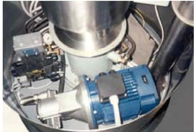
Centralina idraulica separata
