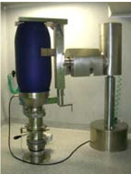
Scarico contenitore con STERI LIFT, tramoggia di scarico, SOLE VALVE e rompigrumi
