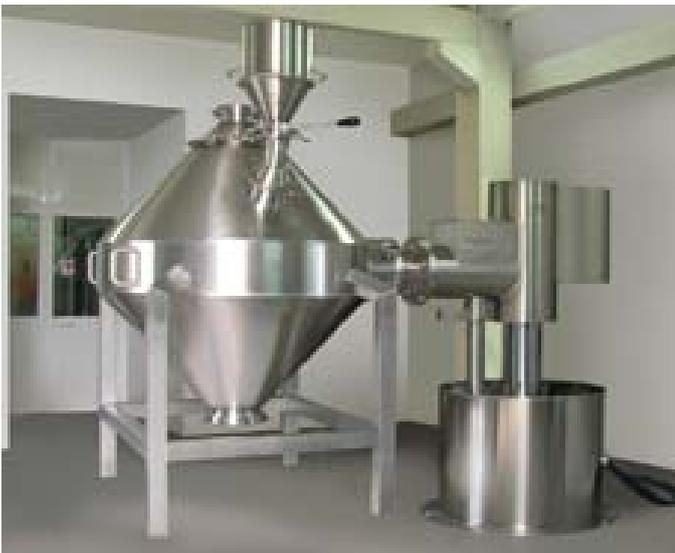
Bicorno da 1300 lt con SOLE VALVE - 1300 lt bicone with SOLE VALVE
