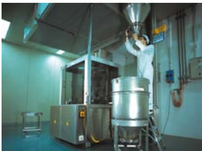
Alimentazione macchina confezionatrice con colonna ribaltafusti. Feeding of a packaging machine with drum lifting and tilting pillar at ELI LILLY S.P.A. Sesto Fiorentino, Firenze
